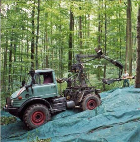
**ABB. 11** Einsatz eines mechanischen Schüttlers zur Ernte von Wildkirschen in einem zugelassenen Bestand. Wichtigste Voraussetzung der Herkunftskontrolle bleibt die Ziehung von Referenzproben. Im Forschungsverbund **HERKUNFTSKONTROLLE** wurden sie unter Aufsicht gezogen.
